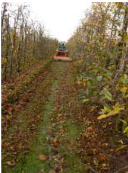
'Gewone' klepelmaaier voor gras, meer en andere klepels dan voor snoeihout Blad fijner versnipperd.
