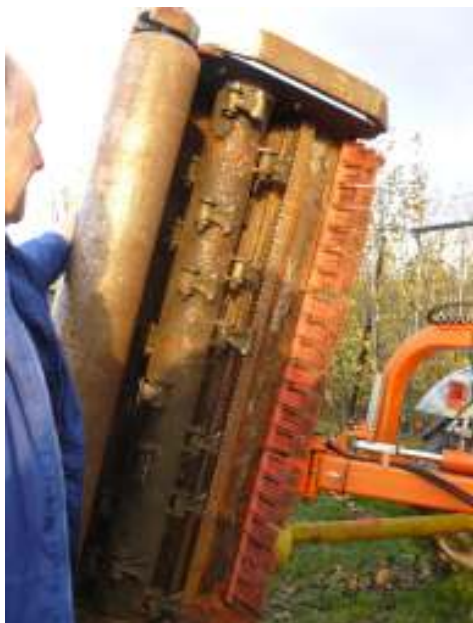
'Gewone' klepelmaaier voor gras, meer en andere klepels dan voor snoeihout Blad fijner versnipperd.
