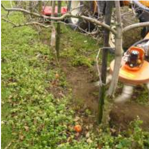
Ook onkruid wordt weggeborsteld borstelkop eigen geleider, kan alle kanten op draaien
