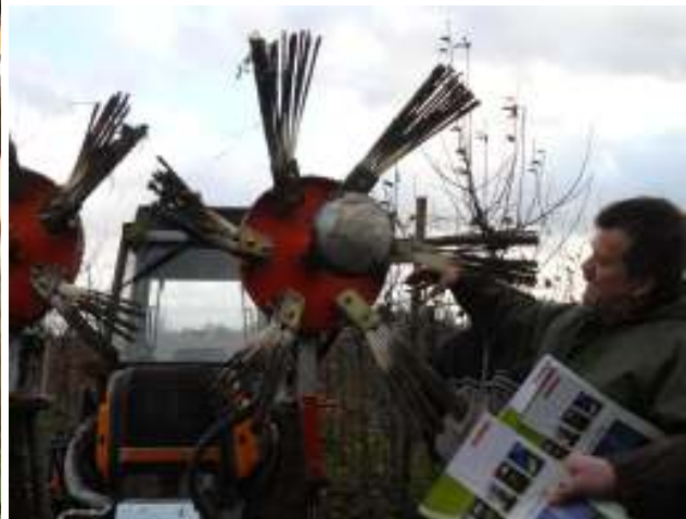
Ook onkruid wordt weggeborsteld borstelkop eigen geleider, kan alle kanten op draaien
